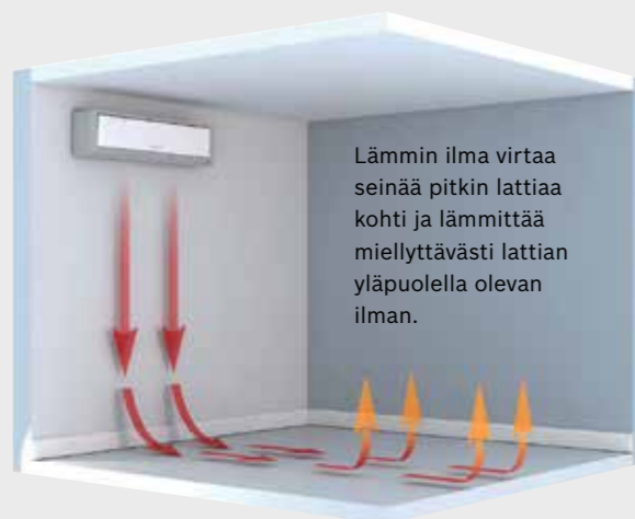
Lämpimän ilman ohjautuminen lämmityskäytössä vedon ehkäisemiseksi
